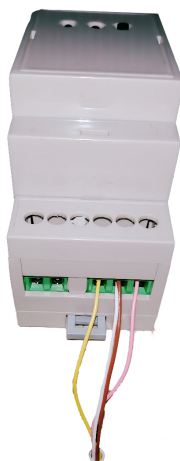
Пример распыки сигнальных клемм (кнопка, подсветка, Modbus)
