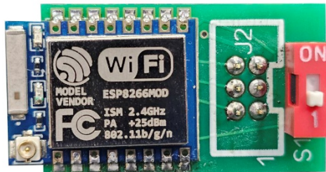
Wi-Fi модуль (ESP8266) с переключателем режима программирования
