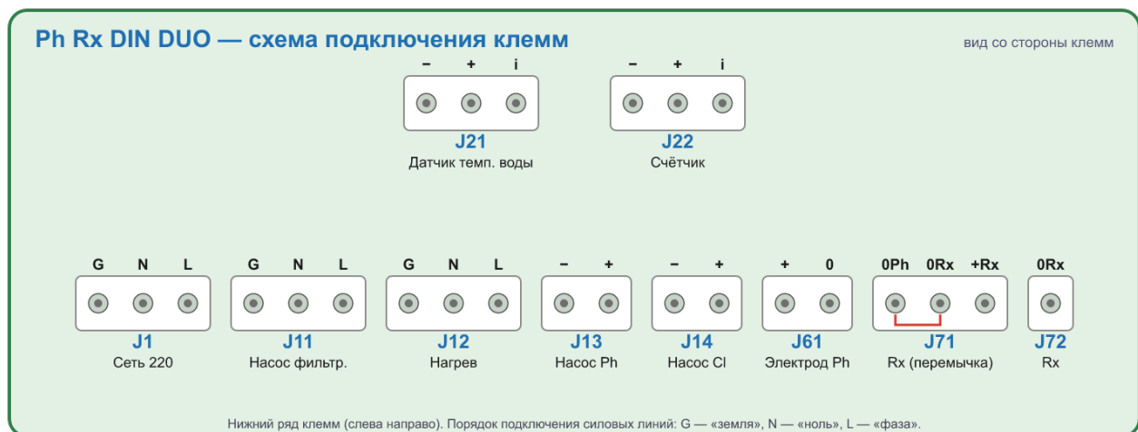
Схема подключения клемм Ph Rx DIN DUO (перерисовка платы)
