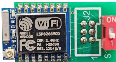
Wi-Fi модуль (ESP8266) с переключателем режима программирования
