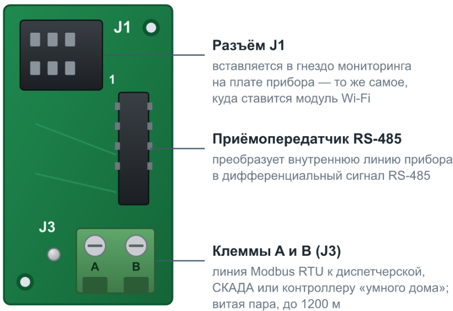
Плата переходника: разъём J1 для установки в прибор, приёмопередатчик RS-485 и клеммы А и В
