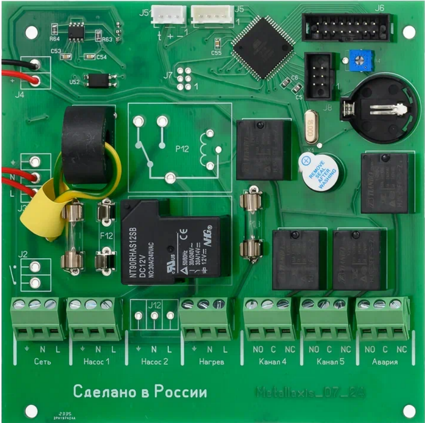
Расположение и назначение клемм и разъёмов на плате устройства
