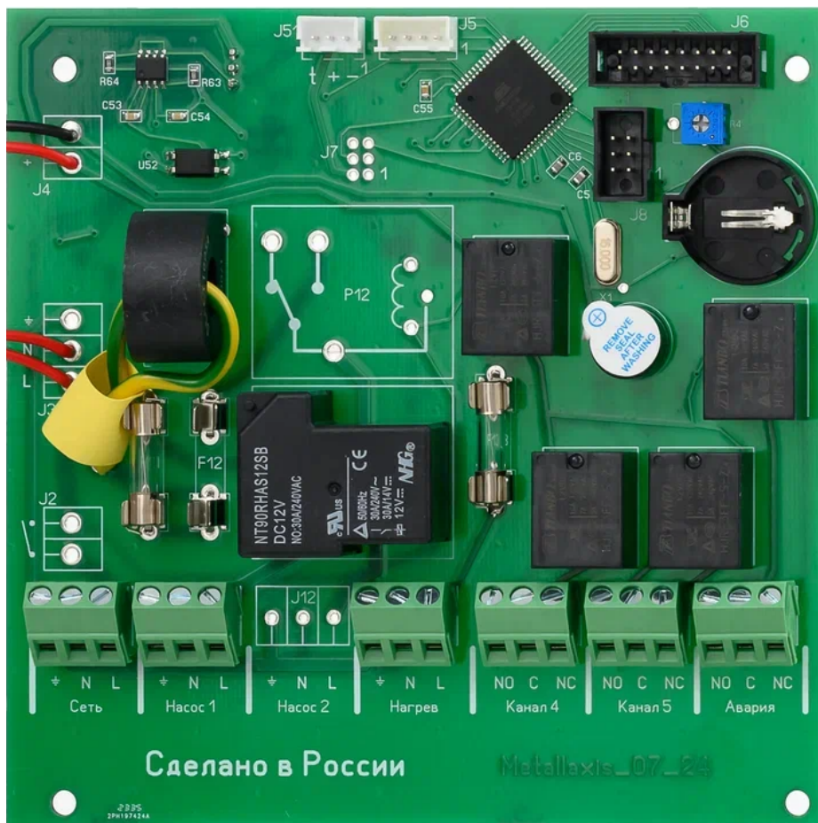
Схема подключения: расположение и назначение клемм на плате устройства
