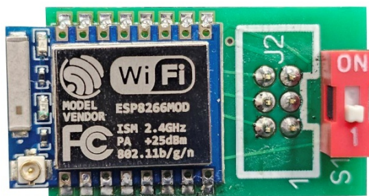
Модуль удалённого мониторинга; справа — переключатель режима
