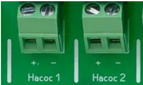
Клеммы подключения насоса подачи реагента: в этом устройстве используется «Насос 1»
