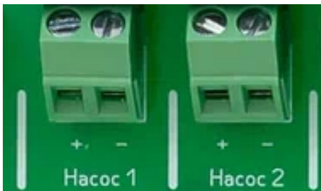
Клеммы дозирующих насосов. В данной модификации задействован только Насос 1 — насос Ph.
