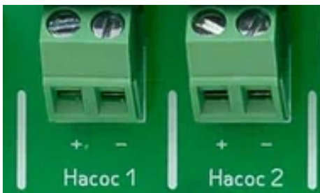
Клеммы подключения дозирующего насоса: в этом устройстве используется «Насос 1»
