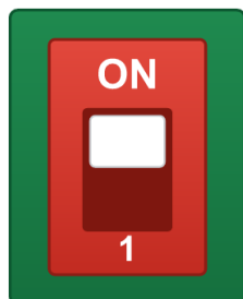
Движок вверх — ON режим настройки Wi-Fi
