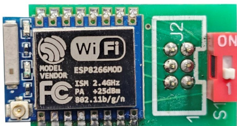
Модуль удалённого мониторинга: переключатель режимов (ON — настройка, 1 — работа)
