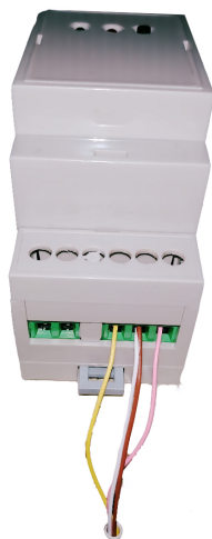
Рис. 3. Пример распыки сигнальных клемм (кнопка, подсветка, Modbus).
