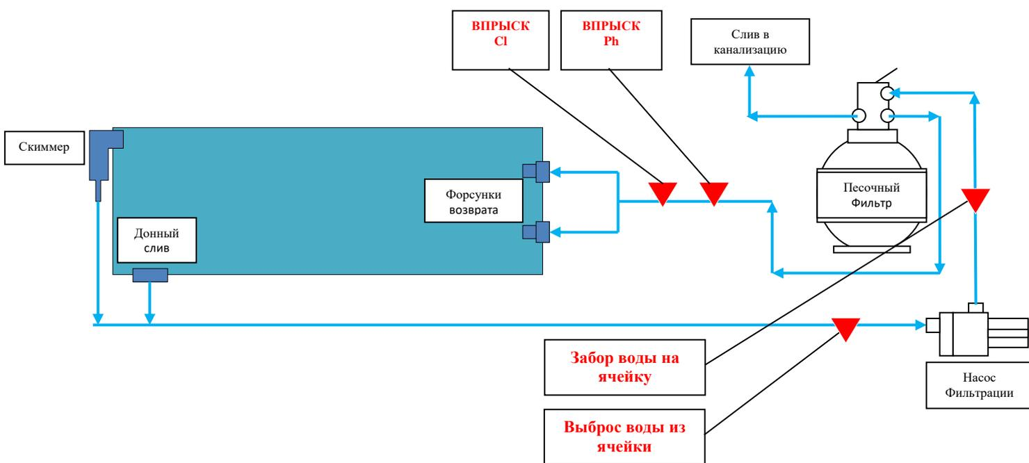
**ВНИМАНИЕ!** Запрещается располагать форсунки впрыска хим. реагентов ближе, чем 40 см. от мест установок электродов либо забора воды на измерительную ячейку. Рекомендуется устанавливать форсунки впрыска на горизонтальном участке трубы.
